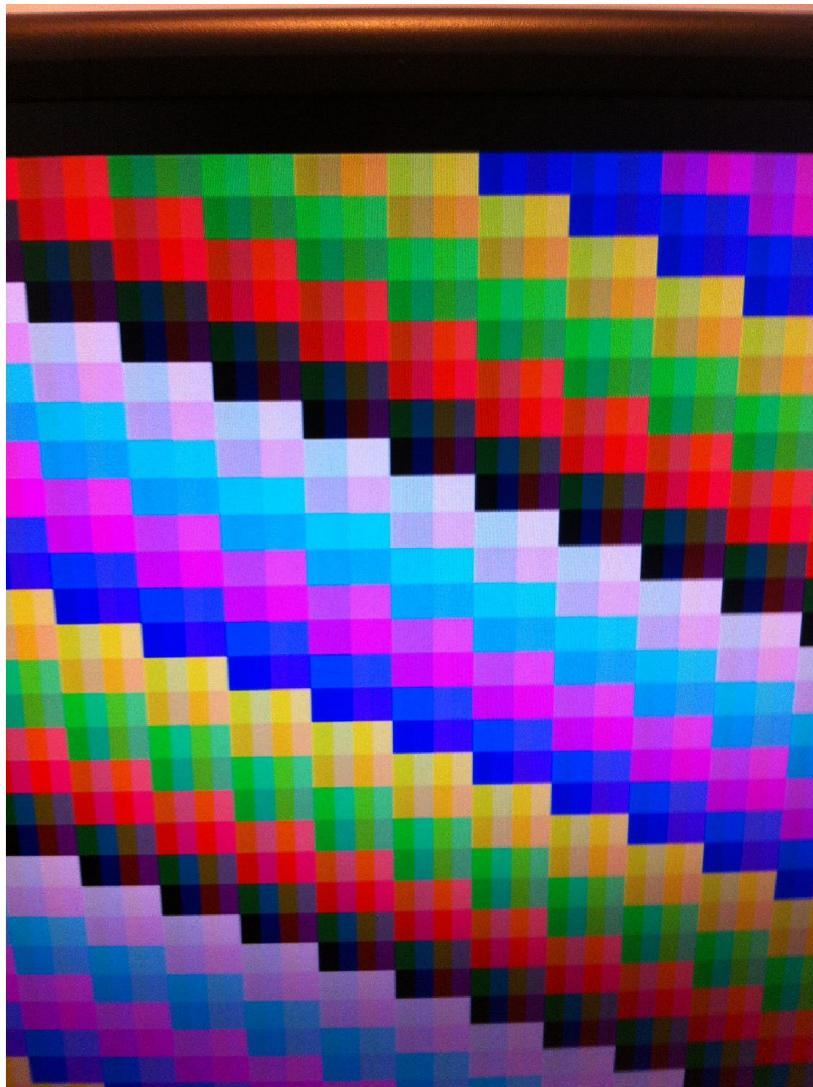
最后，放一张完整的工作照（显示器屏幕没有完全显示，因为 Arduino 所能提供的最高频率有限）
