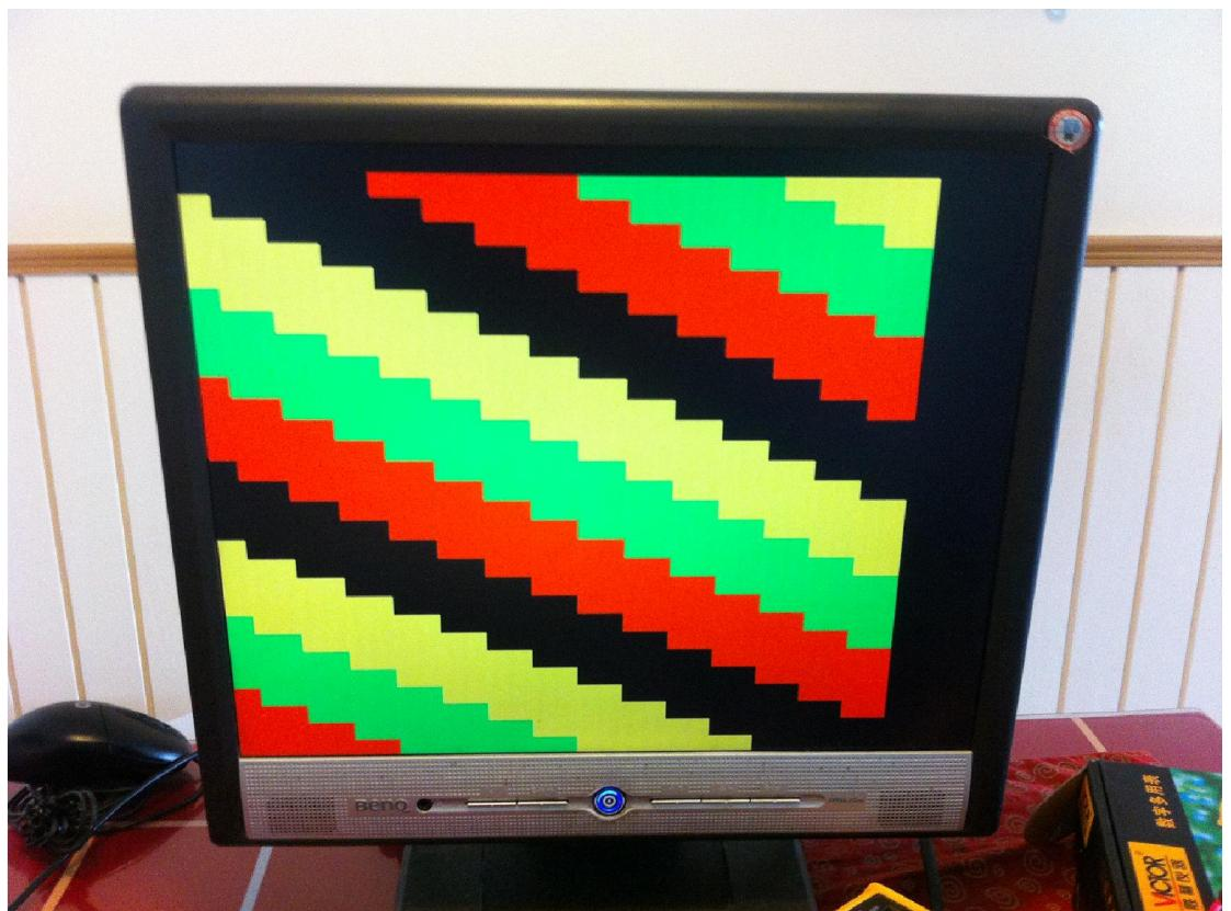
看起来和文章中提到的不同。尝试调试，可以怀疑的只有 RGB 三个信号（Hsync 和 Vsync 错误的时候会无显示）。一个是 RGB 连接的顺序，一个是 RGB 的通断。从上面的图片可以看到，缺少的应该是 Blue 信号，经过检查，确实 Blue 信号连接不良。最后得到的结果是：
