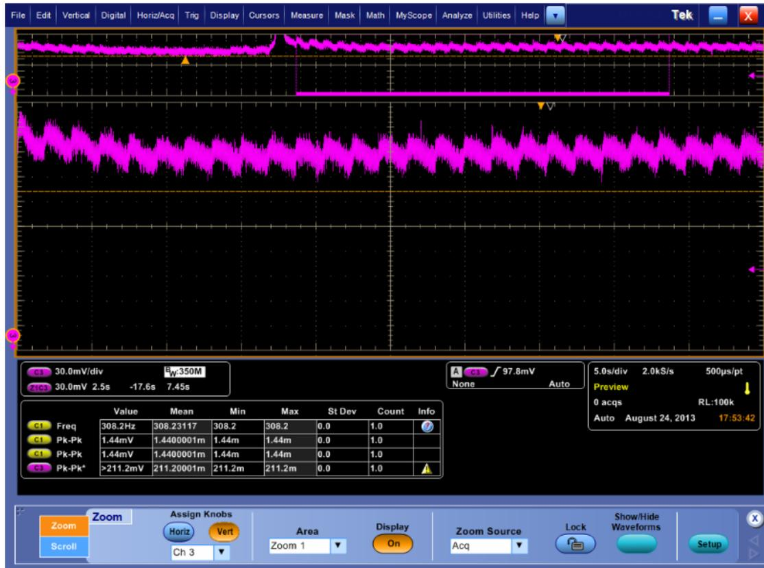
可以看出有信号，40mv 左右的幅度（5V 供电）。在我看来，这样的信号是完全会被淹没在电源的噪音中。刚开始我使用笔记本的 **USB** 为它供电，电源导入的噪音可以说是惨不忍睹，周期性的脉冲会达到电压 10%。后来我换成了干电池，惊奇的发现干电池电压并不会像想象中那样是一条平滑的直线，电压波动差不多是电压的 1%左右。再后来直接用安捷伦的电压发生器，结果和电池一样。实验做到这里，我心凉了半截，一方面是结果说明需要放大电路才能达到要求，另一方面，手指对这个模块的接触会导致信号上的变化，在这样的测试下，为了急于看到结果，制作人员会情不自禁的按下和抬起来获得预期的结果。这也是为什么前面我测试结果“时好时坏”。换句话说，“时好”的情况下并非结果正常而是我自己得到“期望的结果”而已。查看资料也会发现那些商品化的心跳模块都是封闭式的，上面的模块是开放式的结构也可能受到光线的影响。
