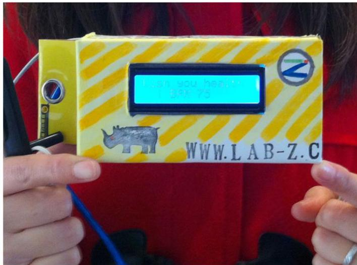
硬件连接上非常简单。心跳模块有 4 个 Pin，分别是 Vcc GND Output 和 Enable。前面两个不用说，Enable Pin 无需连接。Single 接入 Arduino 的 Digital Pin 2。I2C 的 1602 接口连接到对应的 A4 A5（Arduino UNO）即可。
